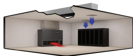
**Abastecimento Frontal Superior e Retorno Frontal:** Projetado para aplicações no local utilizando dutos, este design de fluxo de ar é normalmente usado para aplicações em Telecomunicações ou Industriais. Opções de alta pressão estática e de filtragem podem ser selecionadas.
