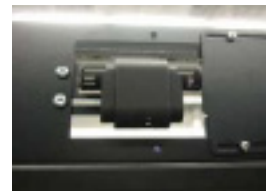
Fig. 8.d Capteur distant de température et d'humidité
