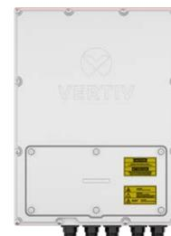
O retificador atende ao grau de proteção IP65 para uso em ambientes externos severos. Opções flexíveis de instalação incluem montagem em poste ou parede, na posição de bandeira ou plana. Conectores rápidos e placa de alívio para tensão de cabos garantem que o tempo para instalar tanto os retificadores quanto as baterias seja mantido em um mínimo.
