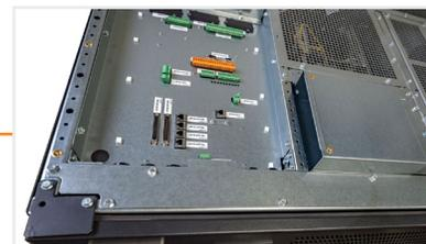
Acesso fácil e seguro às conexões de comunicação e monitoramento via painel superior da unidade - nenhum componente de alta tensão.
